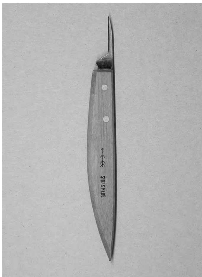
Jürgen Krause, Kerbschnitzmesser (Werkzeug), 2004 - 2005, Klingenbreite 3 mm, ursprünglich 10 mm
